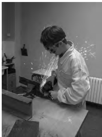
FIGURA 4. Taller «Estem de reformes» 2n cicle ESO: Acabat de peces soldades.
